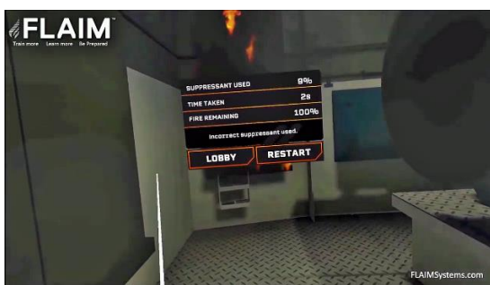
Obr. 15 a 16 Nevhodne zvolený virtuálny vodný PHP na hasenie elektrického rozvádzača veternej elektrárne.
