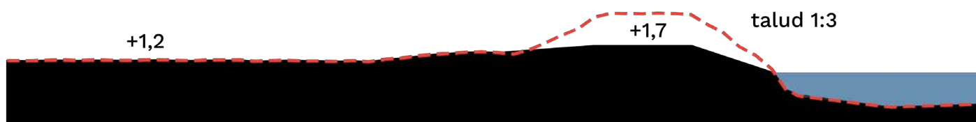
Profiel westkade. Huidige maaiveld wordt verlaagd tot 50 cm boven het omliggende maaiveld en er wordt een flauwere oever toegevoegd
