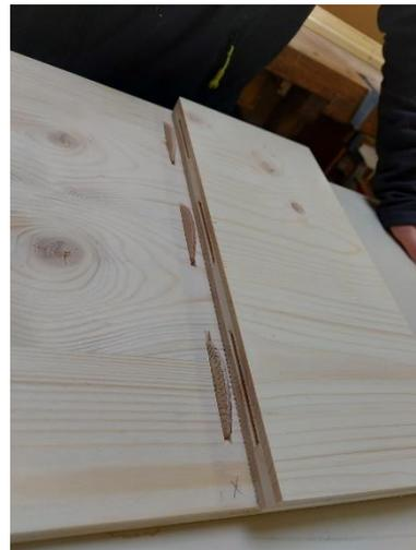
Ein Schüler beim Anreißen des Leistenverbindung. Die Lamello-Verbindung wird zusammengesetzt.
