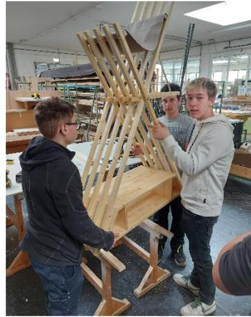
Verschrauben mit Hilfe einer Eckumlenkung. Mit vereinten Kräften war das tolle Werkstück schließlich fertig!
