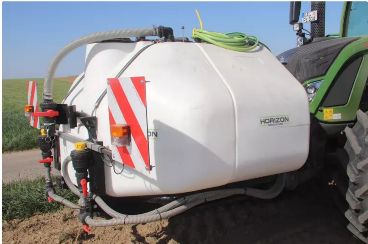
In diesem Fronttank befindet sich der Flüssigdünger zur Ausbringung während der Saat. (Bildquelle: Altmann)
