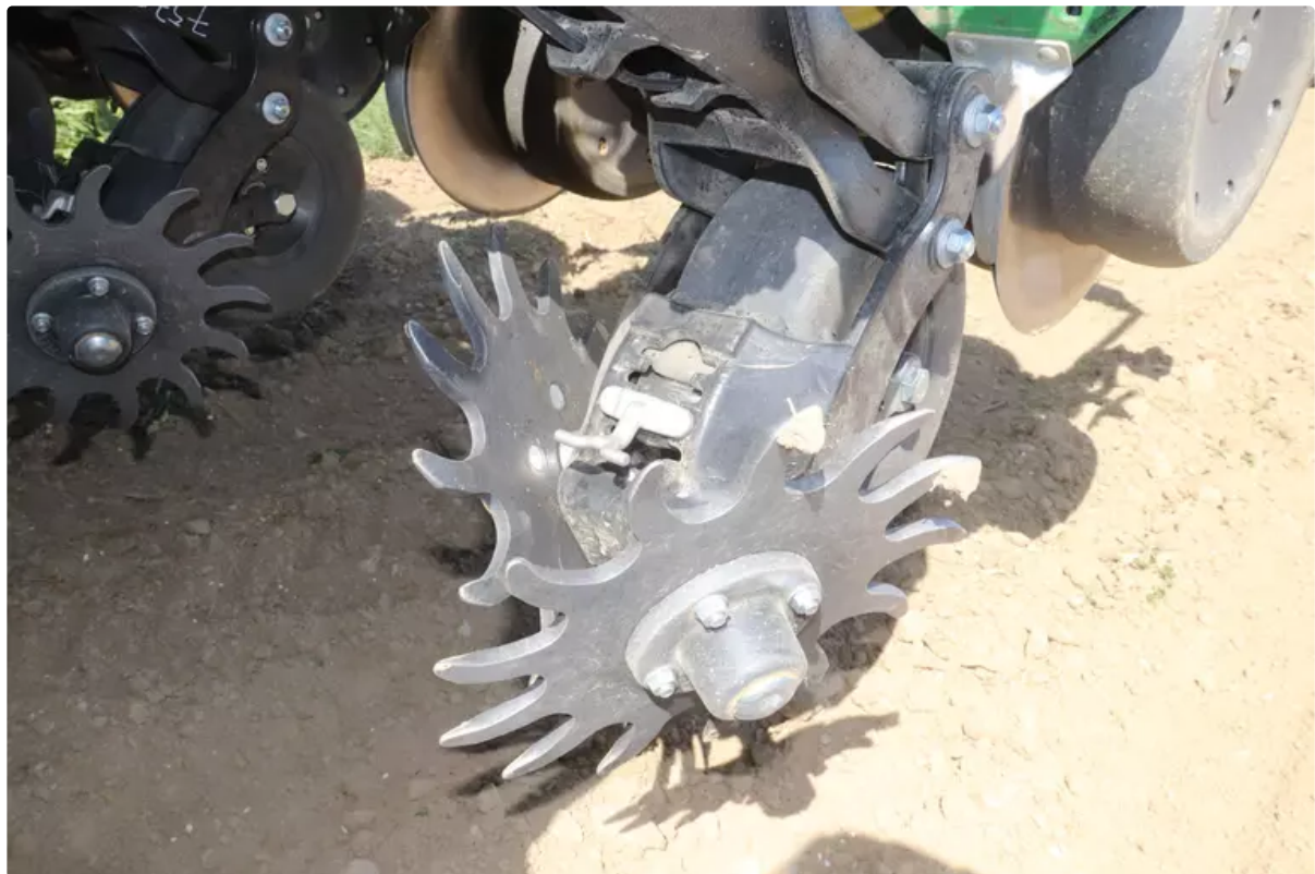
Mit dem Reveal Furchenräumer sollen Steine, Kluten und Stoppelreste etc. aus dem Furchenbereich entfernt werden. (Bildquelle: Altmann)
