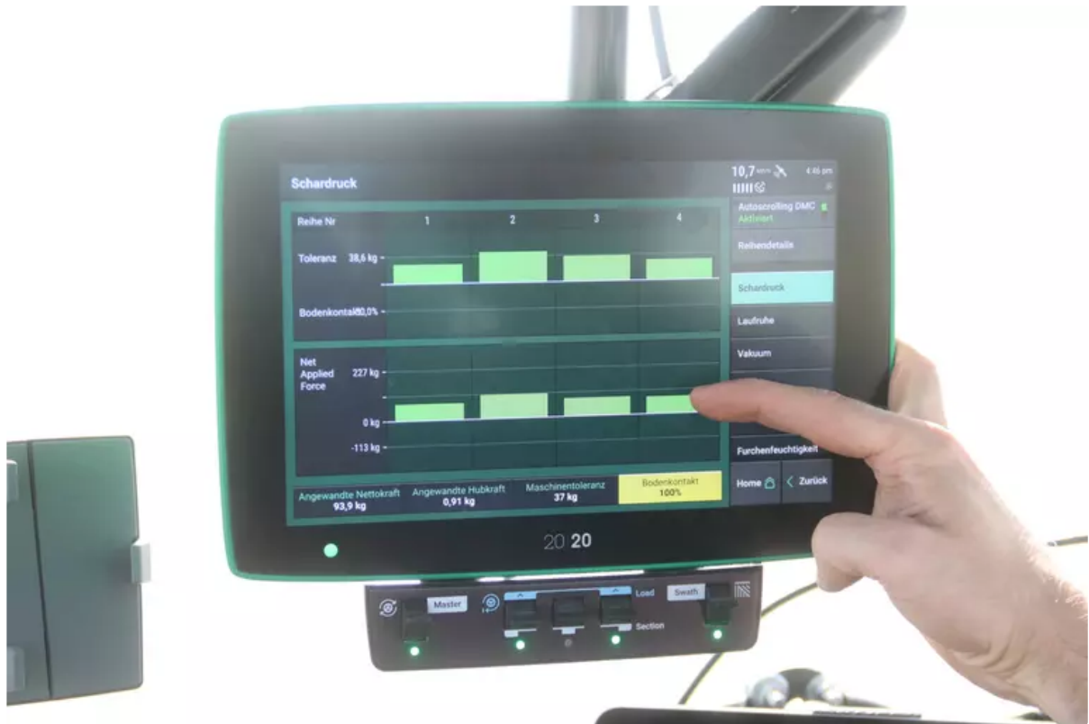
Am Terminal laufen alle Daten zusammen. Hier erklärt Berater Unfried die Schardruckregelung. (Bildquelle: Altmann)
