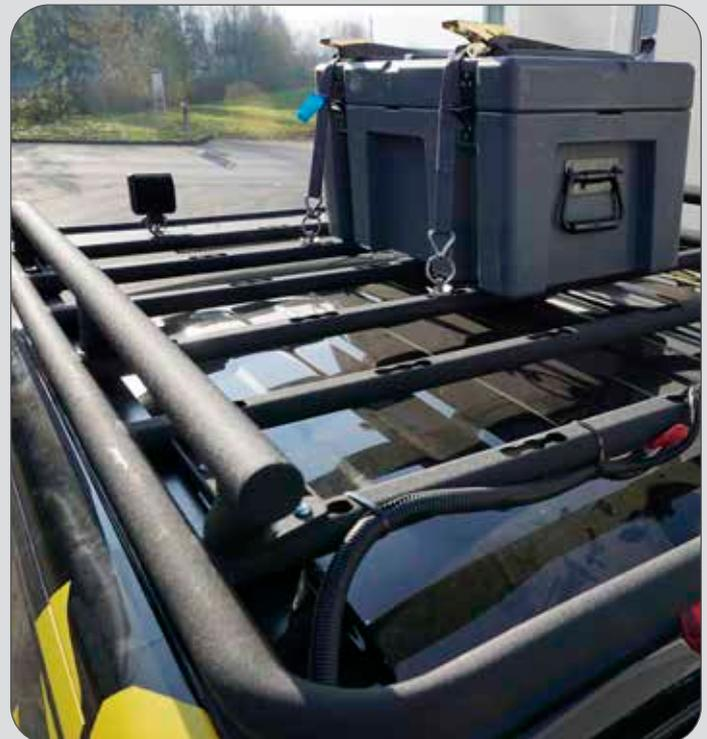
\* Die dynamische Belastbarkeit ist nicht die Freigabe des Herstellers für die Dachlast. Die Dachlast vom Hersteller darf nicht überschritten werden. Die Statische Last gibt die Ladekapazität im Stillstand an.
