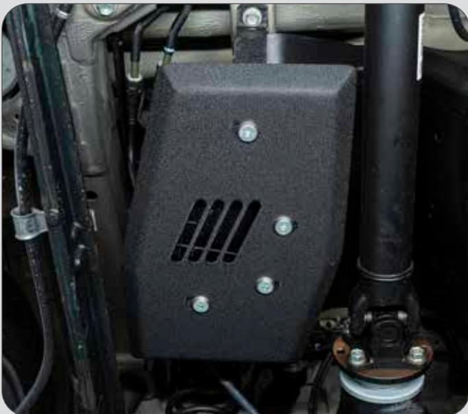
Unterfahrschutz Suzuki® Jimny GJ/HJ Aktivkohlefilter
