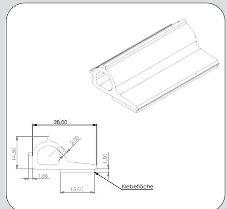
DRYBED PickUp Dichtungs Set Heckklappe
