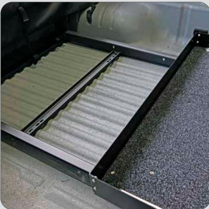
Ein verstärktes Rahmen-System sorgt für die gleichmäßige Lastverteilung. Die Seitenwände sorgen dafür, dass die Ladung auf dem Auszug bleibt, können aber bei Bedarf abgenommen werden .
