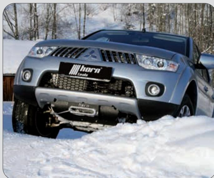
Für die Baujahre 2006 bis 2015 passt das spezielle 4,3to Seilwindensystem für den Mitsubishi®. Die Seilwinde ist in eine Konstruktion eingebettet, die gleichzeitig eine Seilwindenplatte und ein Unterfahrerschutz ist. Durch die Position der Winde entlastet man die Achsen beim Ziehen. Der Böschungswinkel und die Bodenfreiheit bleiben gleich. Die Seilwinde zieht mit einer Geschwindigkeit von 15m/min.
