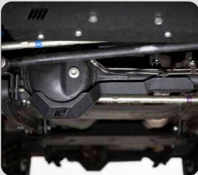
Unterfahrschutz Suzuki® Jimny GJ/HJ Achse vorne
