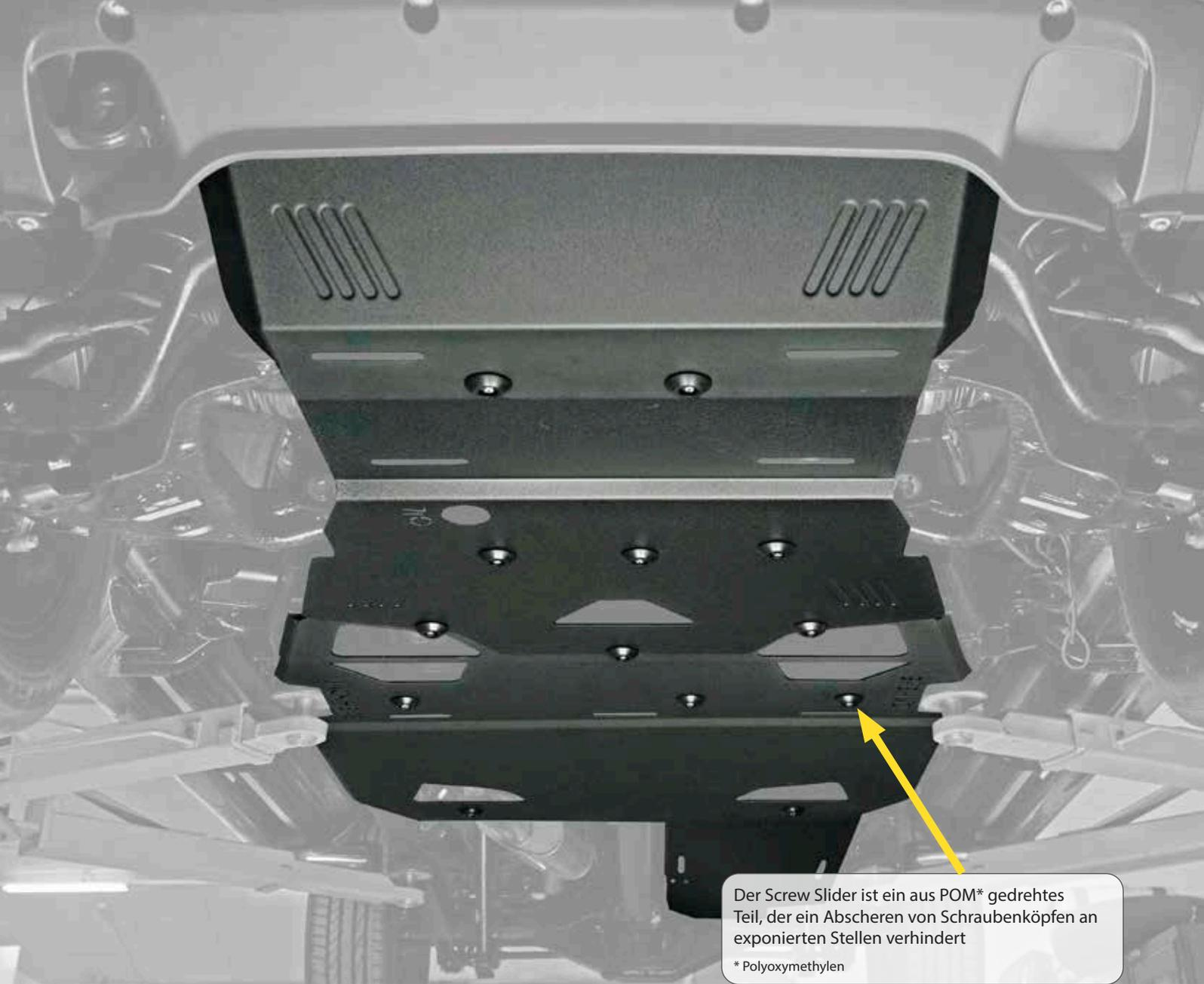
Der Screw Slider ist ein aus POM\* gedrehtes Teil, der ein Abscheren von Schraubenköpfen an exponierten Stellen verhindert
