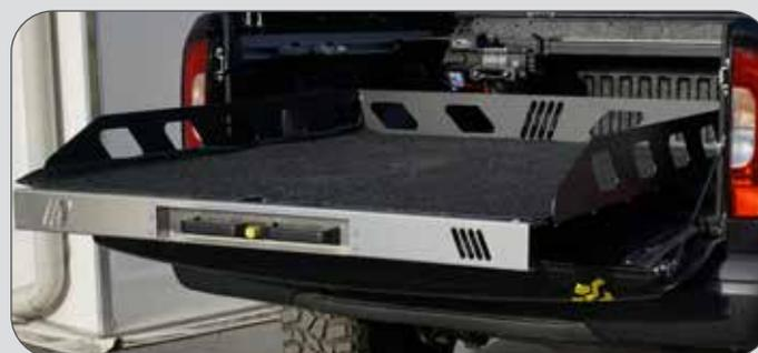
Die abnehmbaren Seitenteile verfügen über Zurrmittel Aufnahmen für große Ratschengurte und Haken, um die Ladung zu sichern. Die Seitenwände sind um 30mm nach außen verstellbar, somit kann die komplette Breite vom Ladebett genutzt werden.
