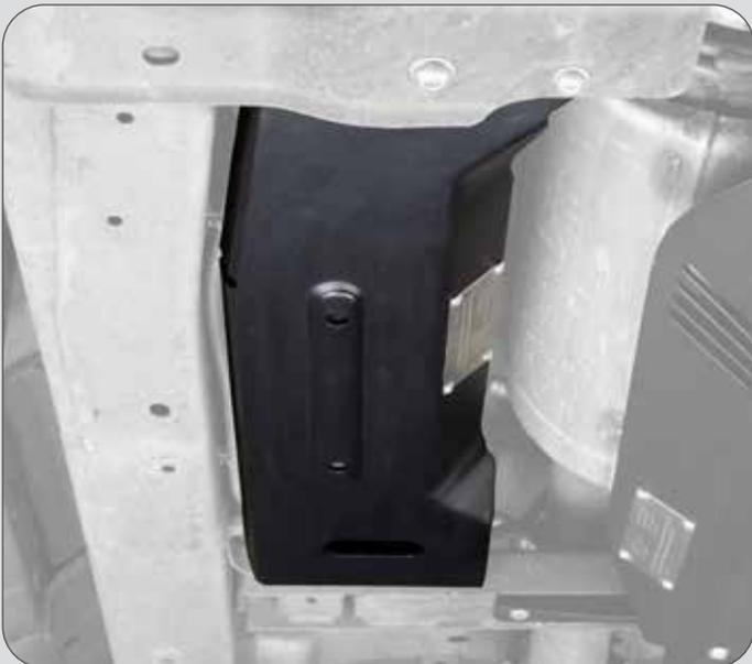
Unterfahrschutz Isuzu® DMAX Steuergeräte
