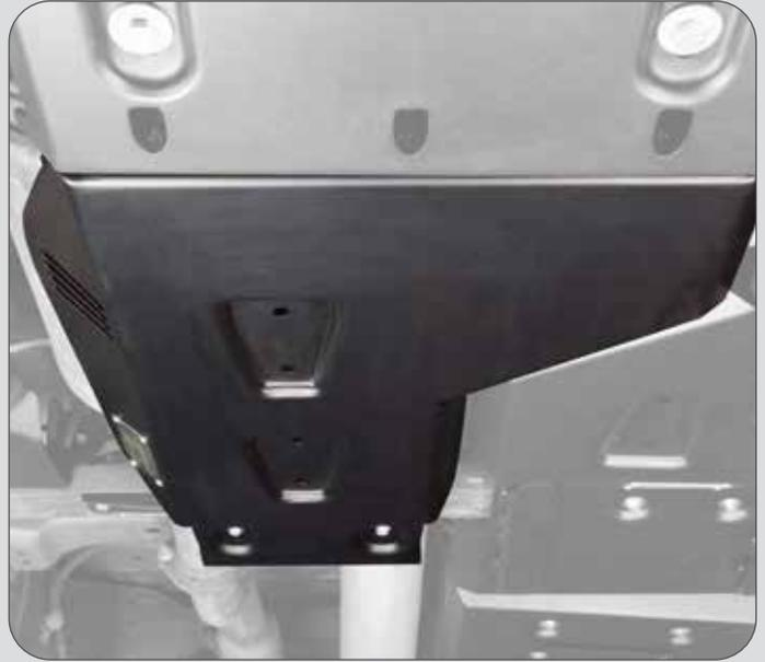
Unterfahrschutz Isuzu® DMAX VTG
