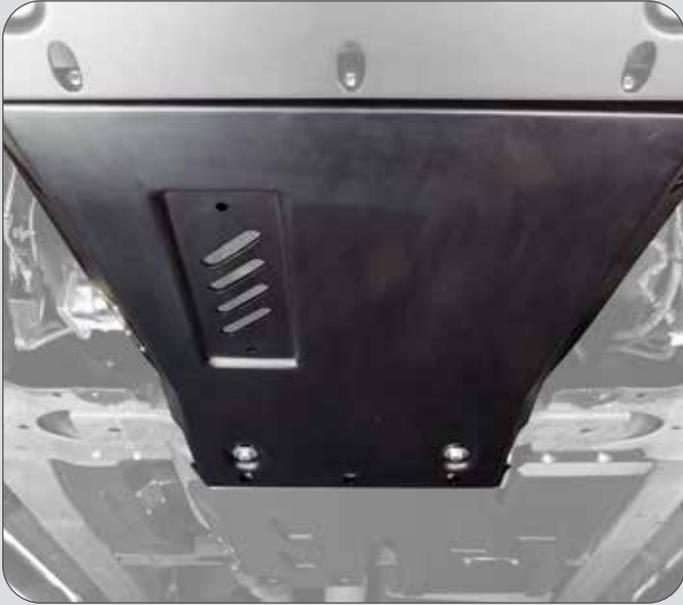
Unterfahrschutz Isuzu® DMAX Getriebe
