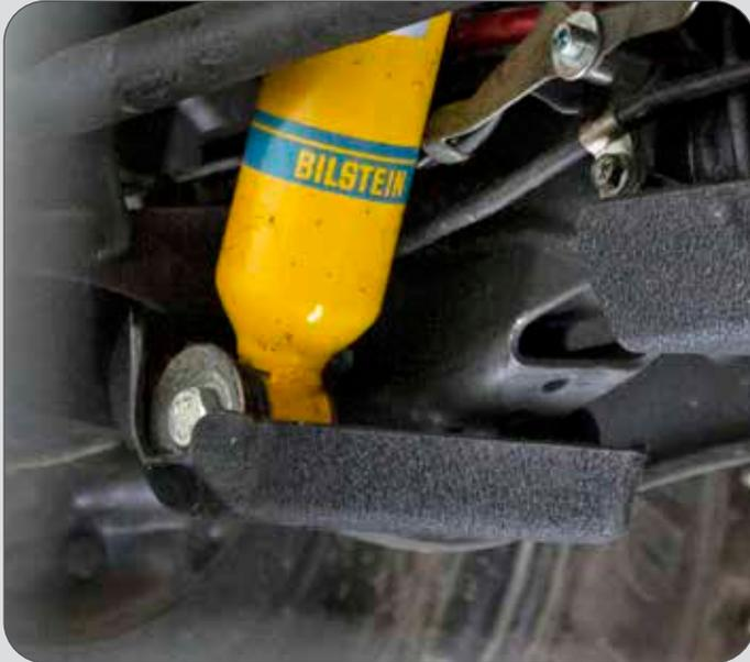
Unterfahrschutz Suzuki® Jimny GJ/HJ Offroad Stoßdämpfer hinten
