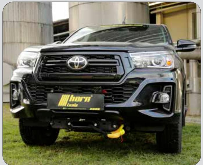
Das Seilwindensystem dient gleichzeitig als Unter- und Anfahrerschutz.
