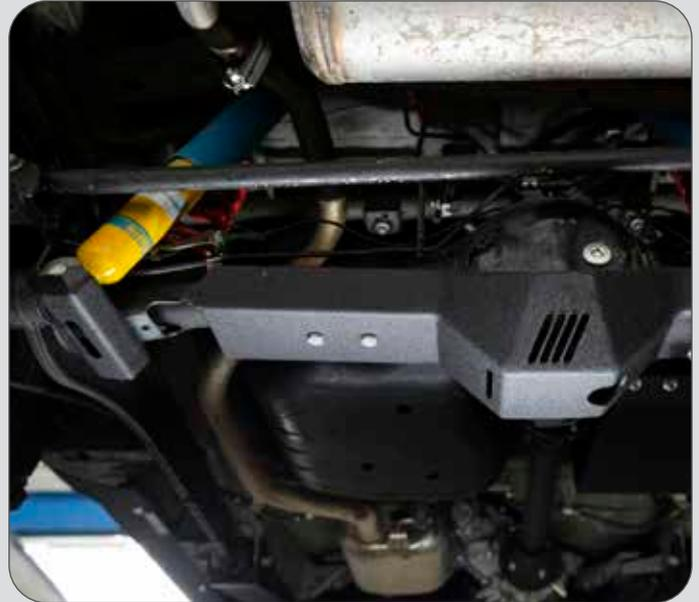
Unterfahrschutz Suzuki® Jimny GJ/HJ Achse hinten
