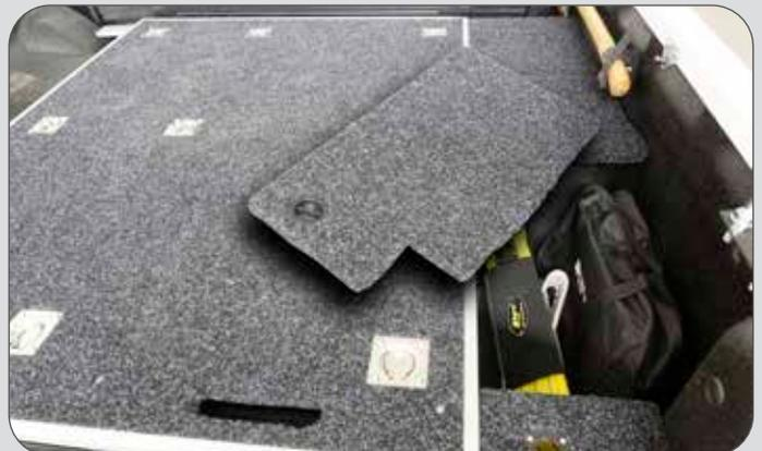
Die Seitenverkleidungen dienen gleichzeitig als großzügige Staufächer. Die Seitenteile sind universell einsetzbar und können individuell zugeschnitten werden (Art-Nr. PHCDSW). Gummistopfen dämpfen Erschütterungen und reduzieren klappernde Geräusche.
