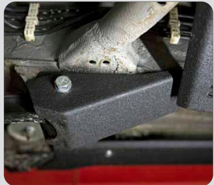
Unterfahrschutz Suzuki® Jimny GJ/HJ Aufnahme Längslenker
