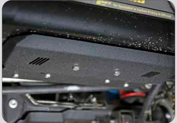
Unterfahrschutz Suzuki® Jimny GJ/HJ Kühler
