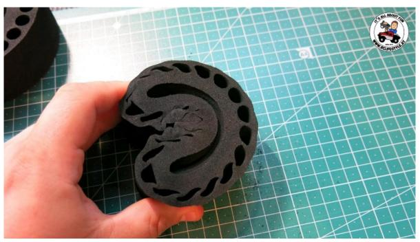
So passt der Foam super in die Reifen-Öffnung und lässt sich anschließend sauber im Reifen verlegen. Weiteres ist speziell bei Beadlock-Felgen darauf zu achten, dass der Foam nicht zwischen dem Felgenring und den äußeren Beadlock-Teilen gequetscht wird. Dies kann nämlich den Foam beschädigen und die Fahrweise beeinflussen.
