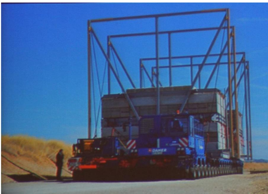
Un moyen de transport spécifique a été réalisé, 46 m de long, 800 tonnes, 352 roues...
