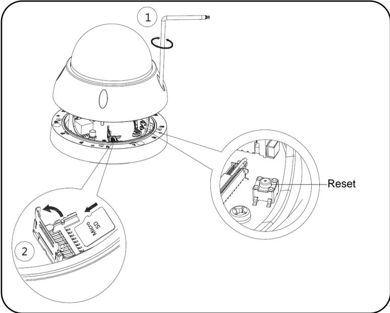
**Nota:** Per il reset (usato per tornare ai valori di fabbrica), premere il tasto Reset per 8 secondi; l'indicatore luminoso si spegnerà.
