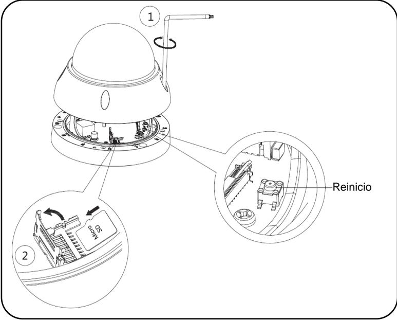
**Nota:** Para realizar un Reset (restaurar los ajustes de fábrica de la cámara), mantenga presionado el botón Reset durante 8 segundos y la luz se apagará.
