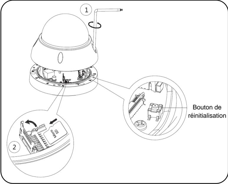
**Remarque :** Pour réinitialiser la caméra (c.-à-d. rétablir ses paramètres par défaut), appuyez sur le bouton de réinitialisation pendant 8 secondes ; le voyant s'éteint.
