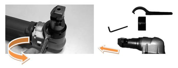
2. Kolbenbüchse nach vorne abziehen um den Stempel freizulegen
