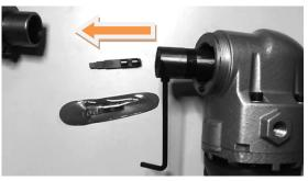
4. Neuen Stempel wieder einsetzen und mittels Kerbe am Stempel in Richtung Innensechskantschraube positionieren und festziehen.
