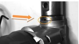
6. Befestigungsschraube der Kolbenbüchse wieder anschrauben und gut festziehen (Schlüssel Halbmond)
