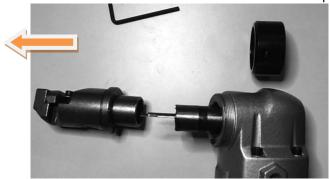
3. Innensechskantschraube vom Stempel lösen und abgenutzten Stempel nach vorne herausziehen.
