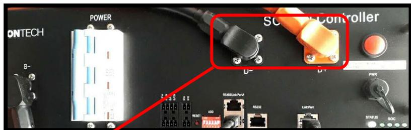
Kabelenden mit Schnellverschluss-Steckern für den Anschluss an das **BMS**
