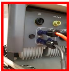
Die Batteriekanäle im Inverter entsprechend der Konfiguration der Batterietürme einstellen.
