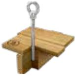
Das Gewinde dieses gradlinigen Edelstahl-Anschlagpunkts (Ø 16 mm) wird durch die Holzschalung direkt in den Sparren geschraubt. Bohren Sie dafür ein Loch durch die Schalung (min. 18 mm) in den tragfähigen Holz-Balken (min. 80 mm x 120 mm).
