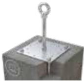
Installieren Sie diesen in jede Richtung belastbaren Edelstahl-Anschlagpunkt (Ø 16 mm) bereits ab einer Einbautiefe von nur 65 mm. Die Grundplatte (200 x 200 mm) des Sekuranten wird mit 4 mitgelieferten Einschlagdübeln dauerhaft im Beton-Untergrund verankert.
