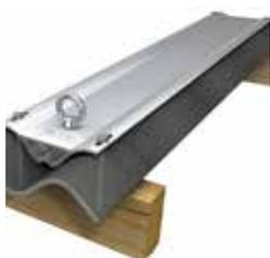
Aluminium Anschlagereinrichtung mit Edelstahl-Ringöse zur fixen Montage. Spezielle Form für Welleternit-Dächer (Wellenabstand 177mm). Befestigung mit vier Edelstahlschrauben in zwei Sparren. Die 125cm lange Grundplatte wird bei Bedarf vor Ort auf den jeweiligen Sparrenabstand gekürzt. Inkl. Befestigungsmaterial.
