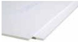
Fermacell Gipsfaser-Elemente bestehen aus zwei miteinander verklebten Gipsfaserplatten. Diese beiden Platten sind gegeneinander versetzt angeordnet, so dass ein 50mm breiter Stufenfalz entsteht.
