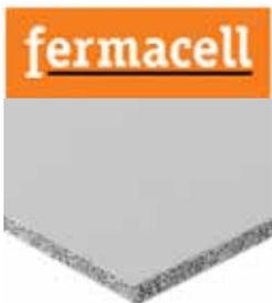
Zementgebundene, glasfaserbewehrte Sandwichplatte, die Leichtzuschlagstoffe in form von Blähgranulat (Mittelschicht) und Recycling-Glasschaubgranulat (in beiden Deckschichten) enthält.
