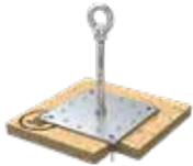
Der bauaufsichtlich zugelassene Anschlagpunkt (Ø 16 mm) verfügt über eine Grundplatte (200 x 200 mm) und wird direkt von oben auf die Schalung geschraubt. Zum Lieferumfang gehören 16 hochwertige Schrauben, die wie das gesamte System aus witterungsbeständigem Edelstahl gefertigt sind.
