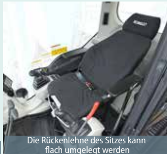
Die Sitzfederung absorbiert Vibrationen
