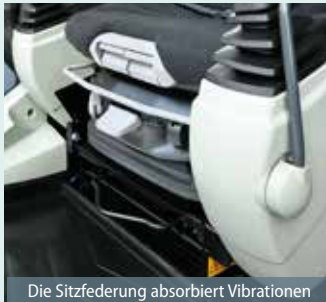
Die Sitzfederung absorbiert Vibrationen
