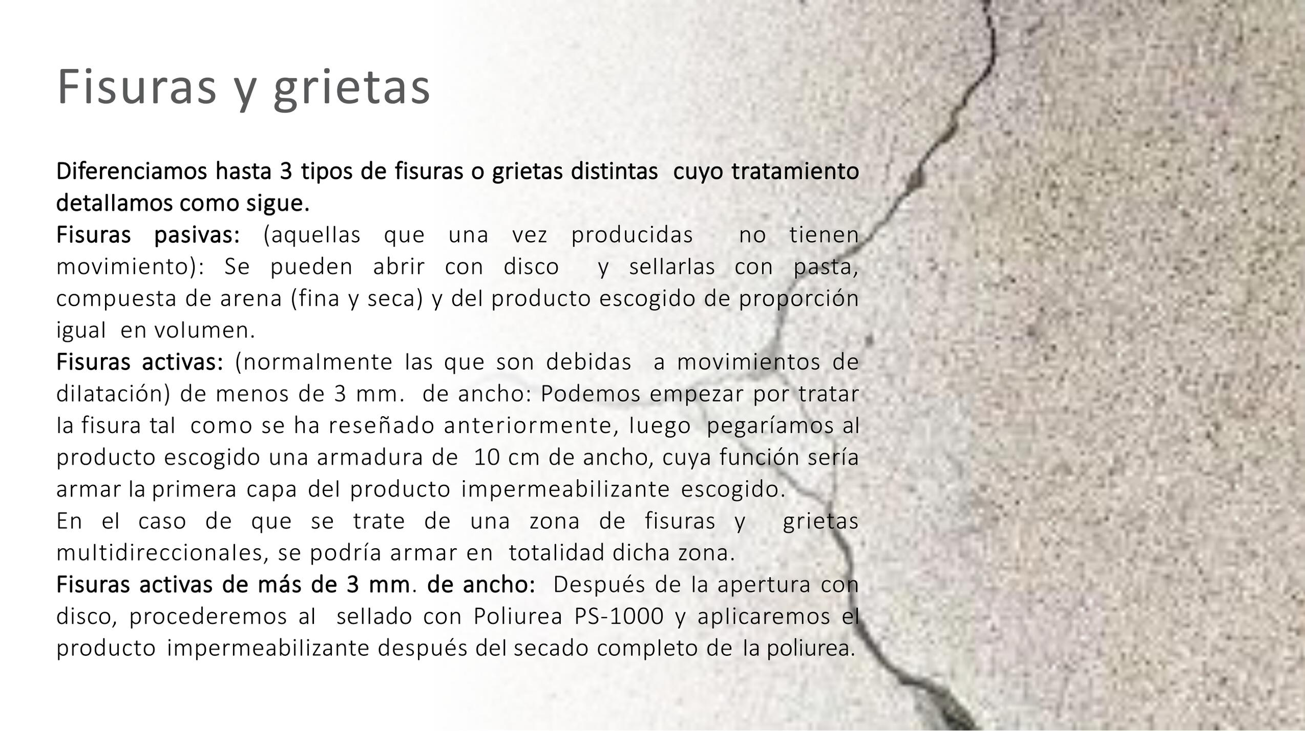
Diferenciamos hasta 3 tipos de fisuras o grietas distintas cuyo tratamiento detallamos como sigue.
