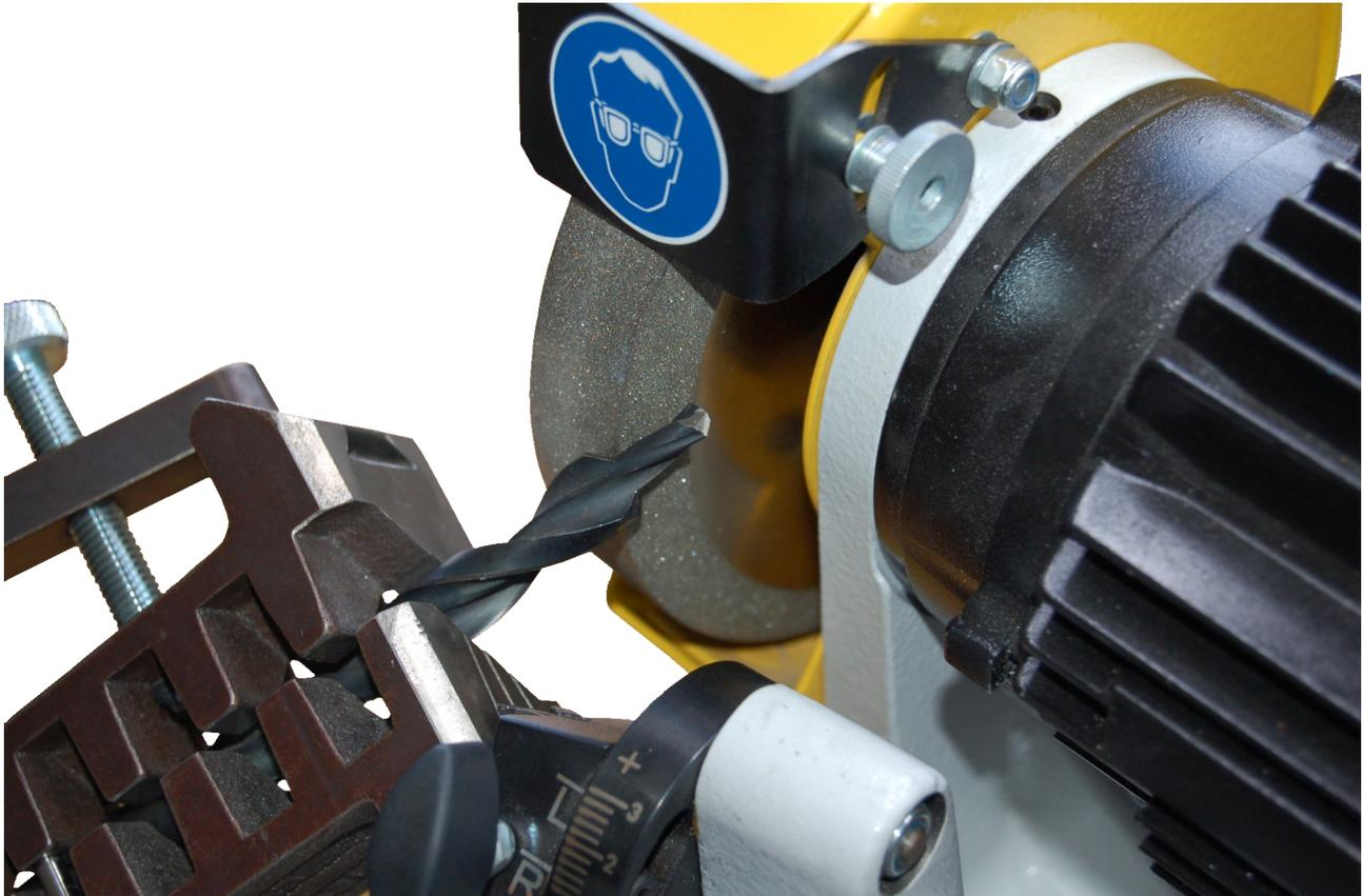
Schleifen der 1. Stufe (Spitze): Ausrichtung und Schleifvorgang wie beim rechtsschneidenden Spiralbohrer (siehe Bild unten).
