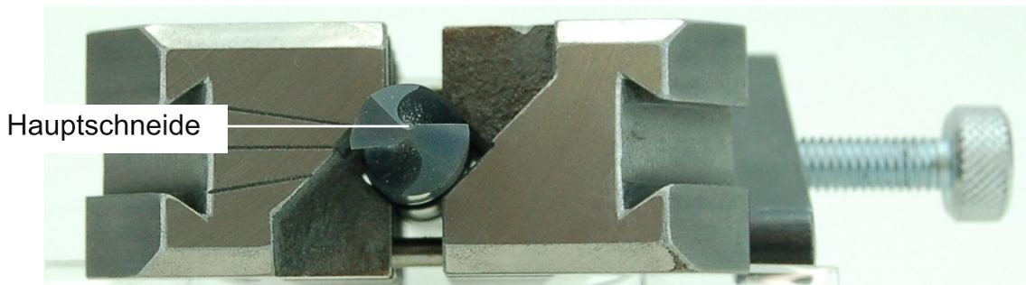
Lassen Sie den Bohrer ca. 20-25 mm über die Prismenkante überstehen. Mit der Rändelschraube wird das Prisma leicht zusammengedreht, so dass sich der eingelegte Bohrer im Prisma noch drehen lässt. Richten Sie nun die Hauptschneide so aus, dass sie innerhalb der Einstellstrichen liegt (siehe Bild oben). Das Prisma nun mittels der Rändelschraube fest anziehen (ohne Gewalt). Der Bohrer ist nun zum Schleifen ausgerichtet.
