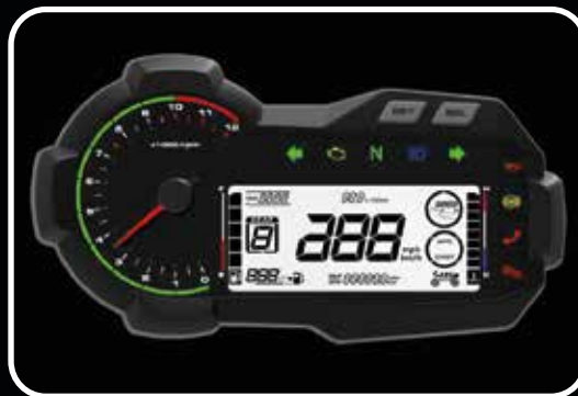
LCD-DISPLAY MIT HÖHENMESSER ÉCRAN LCD AVEC ALTIMÈTRE
