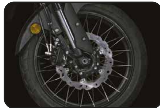
NISSIN BREMSE MIT BOSCH ABS FREINS NISSIN AVEC ABS BOSCH
