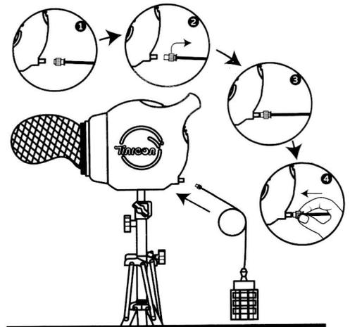
3. Befestigen Sie den Schlauch (Halten Sie den Schnittstellenring fest, schieben Sie ihn zurück, richten Sie ihn aus und drücken Sie ihn in Richtung der Schnittstelle, und schieben Sie schließlich den Schnittstellenring nach vorne, um sicherzustellen, dass die Schnittstelle abgeschlossen ist).
