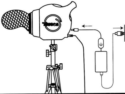
4. Schließen Sie das Gerät an die Stromversorgung an.
