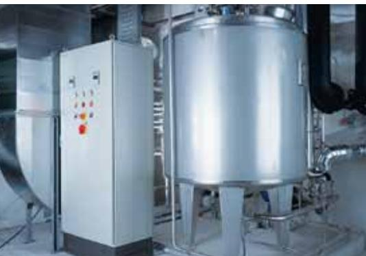
Vollautomatische CIP-Station zur Versorgung aller Teilanlagen mit CIP-Medien
