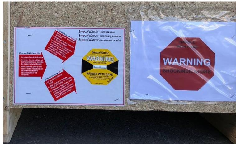
Рисунок 2. Расположение индикатора удара
