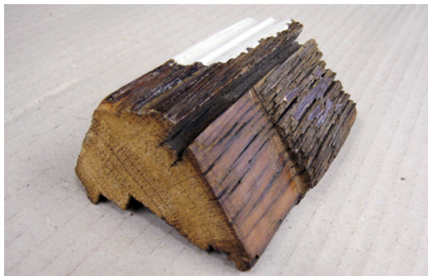
6. Der Schein trügt: ein oberflächlich kaputter Wetterschenkel von ca. 1900, in der Grundsubstanz kerngesund und durch „Gesundschneiden“ wieder revitalisiert. Foto: Johannes Mosler.
