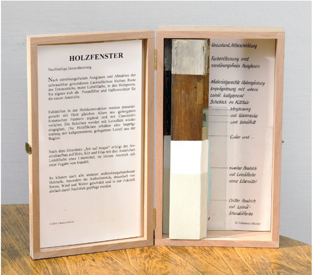
9. Musterprofil: Holzfenster, Instandsetzung und nachhaltige Konservierung. Foto: Johannes Mosler.
