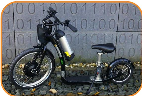
Das Original Hightech Laufrad zum Behinderungsausgleich mit elektromotorischem Antrieb zur Laufunterstützung.
