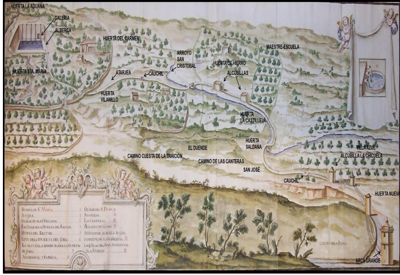
Figura 1.- Croquis de la atarjea de las Aguas del Cabildo desde sus captaciones hasta Puerta Osario (según el manuscrito MS-165, Archivo Capitular de la Catedral de Córdoba, modificado por los autores).
