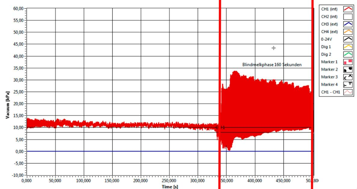
Abbildung 1: Langzeitmessung des Kopfvakuums zur Bestimmung der Passgenauigkeit des Zitzengummis und zur Bestimmung der Blindmelkphase
