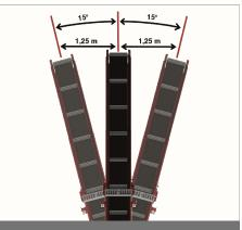
Das schwenkbare Förderband ermöglicht eine einfache und praktische Beladung des Anhängers oder der Gitterboxen. Die Steuerung des Förderbandes befindet sich direkt neben der Hauptsteuerung der Säge.
