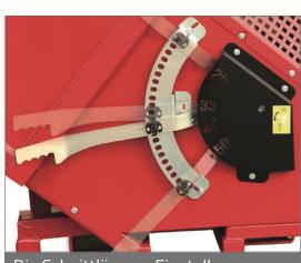
Die Schnittlängen-Einstellung von 25 – 52 cm ist einfach ohne Werkzeug möglich.Es ist kein Trommelwechsel notwendig.
