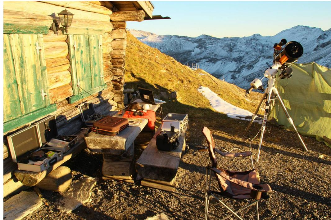
Neben dem eigentlichen Teleskop mit Montierung jede Menge Kabel, Adapter, Netzteile Okulare und anderes Zubehör verstaut in mehreren Koffern.
