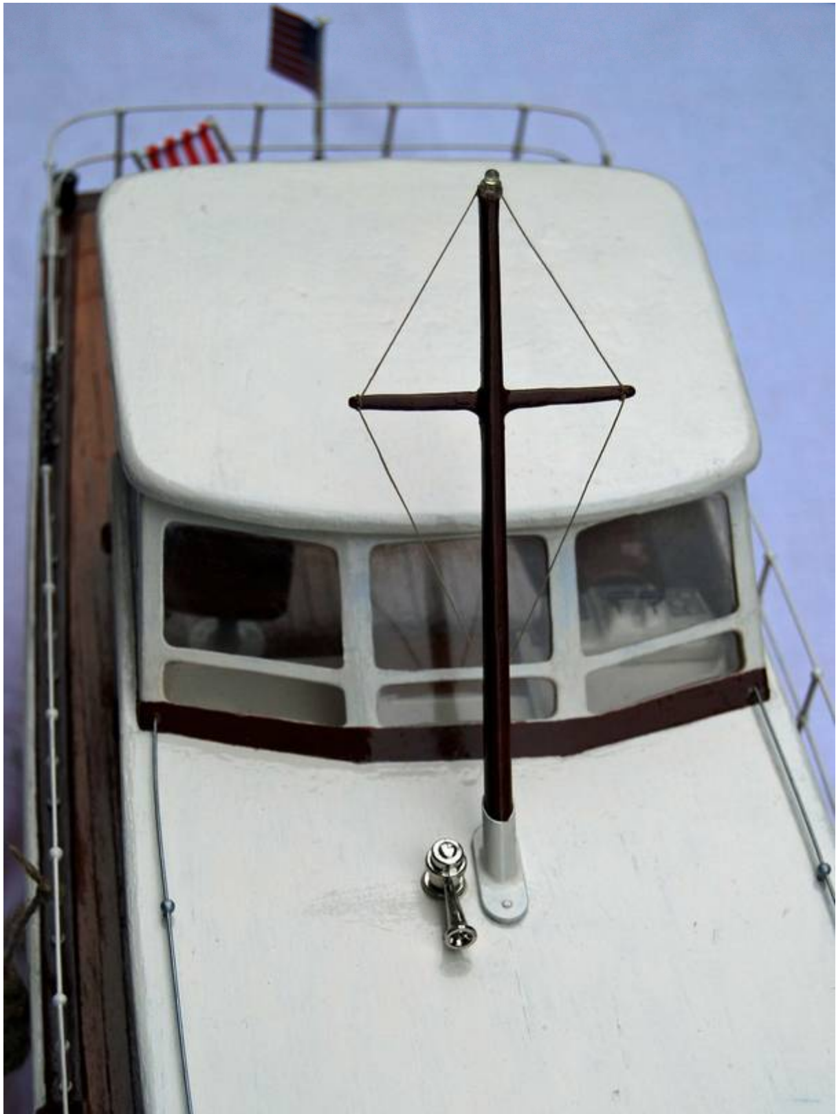
Bild 17: Mast und Halterung montiert, daneben das Signalhorn
