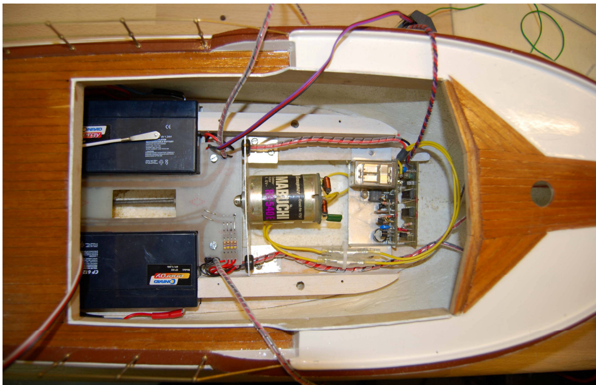
Bild 10: Blick in den Rumpf, rechts der Fahrtenregler, in der Mitte der Motor, links die beiden Akkus
