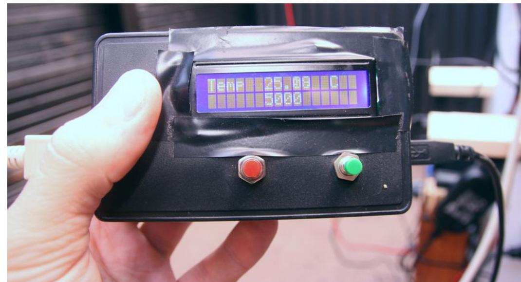
Die Kontrollbox mit LCD Anzeige für Temperatur und Motorschritte und Tastern zum Fahren des Motors in beide Richtungen. Die Stromversorgung und das Aufspielen der Software erfolgt über ein USB Kabel.
