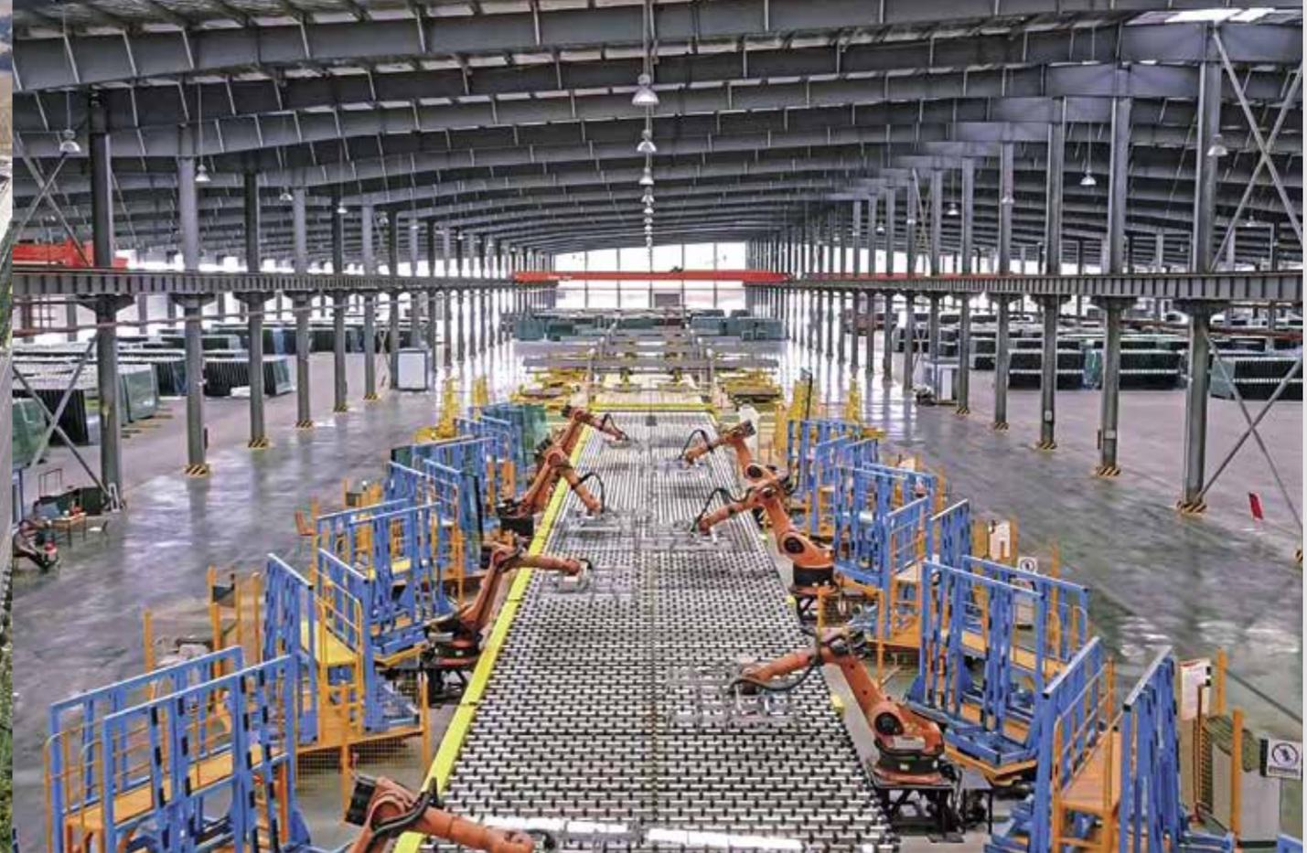
Floatglas ist ein Flachglas, das in einem speziellen Verfahren hergestellt und etwa für Fenstergläser, Autoscheiben und Spiegel verwendet wird. Auf einer zweiten Produktionslinie sollen energieeffiziente Lackierungen, medizinische Gläser sowie Glasfaser hergestellt werden.
