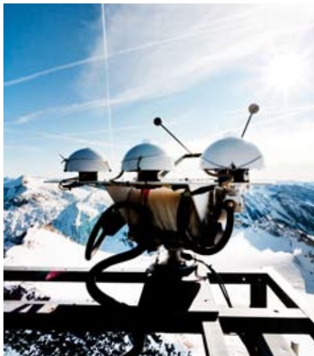
Hochgebirge trifft auf moderne Technik. Alle drei Geräte im Freien (links) messen die Sonnenstrahlung. Die Glaskugel (ganz links) ist nicht für Wetterhexen, sondern ein Sonnenschein-autograf: Die Sonnenstunden liest man an einem Streifen ab, der durch das gebündelte Licht auf Papier gebrannt wird. Das walzenförmige Gerät (unten) erinnert an vergangene Tage: der Windmesser im alten Holzturm der Warte.
