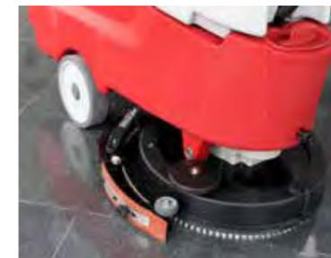
Saugbalken schwenkt automatisch in die Arbeitsrichtung.
