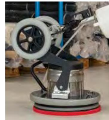
Kippbare Deichsel zur Erhöhung des Anpressdruckes.
