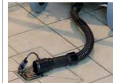
Schmutzwasser-Ablassschlauch (Knickschlauch) zum bequemen, restlosen Entleeren des Behälters.
