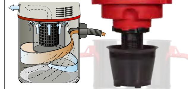
Durch den Drall am Einlaßstutzen wird der Sprühnebel an der Behälterwand abgeschieden. Zusätzliche Filterstoffe sind nicht mehr notwendig. Die zuverlässige Schwimmerabschaltung reagiert selbst bei extremer Schaumbildung. Seitliche Kühl-Luftschnitte sorgen für konsequente Trennung von Kühl- und Prozessluft.
