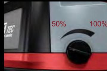
Stufenlos einstellbarer ECO-Modus
