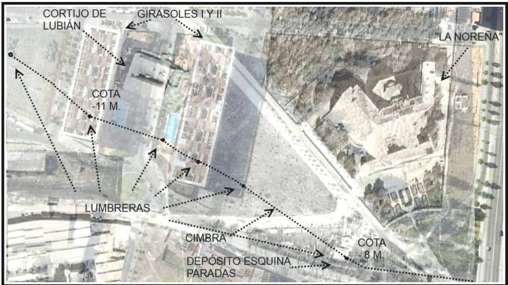
Fig. (16). Imagen compuesta del vuelo del 56 con el barrio en la actualidad. Hemos dibujado sobre ella la traza del Qanat con sus lumbreras.
