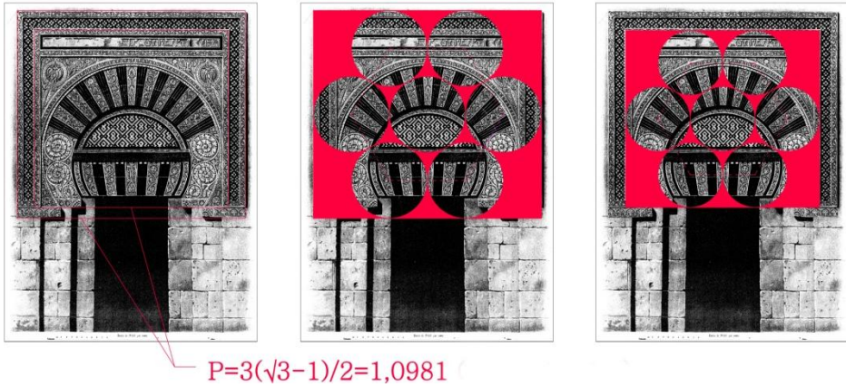
Fig.9. Portada de Alhakan II. Mezquita de Córdoba. Siglo X. Comprobamos en recercados de alfiles, por duplicado y en la misma portada, la proporción P=3(\sqrt{3}-1)/2=1,0981 .
