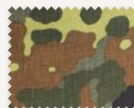
**110DTEX PA6.6 SILICON** (100% Polyamid). Leichtes, doppelseitig silikonbeschichtetes und bedrucktes Nylon-Gewebe im 5-Farb-Tarndruck. Das Material gemäß TL 8305-0278 wird für Regenhüllen verwendet.
