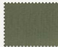
**T-SQUARE RIP FD** (100% Polyamid) Die sehr enge, spezielle Webweise der 210 den-Fasern macht diesen Stoff äußerst stabil, er bleibt dabei aber extrem leicht. Durch die Verwendung von FD-Garn (Full-Dull) bekommt der Stoff eine matte Oberfläche.
