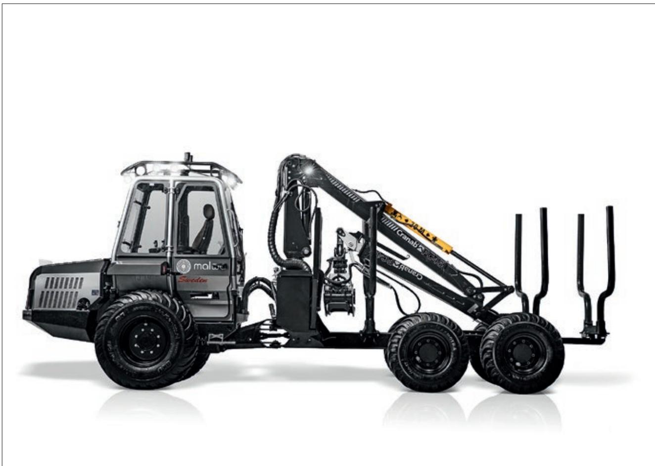
Débardeur conçu pour se déplacer sur le site d'exploitation, capacité de chargement de 5 500 kg ou 9 000 kg en combinaison avec une remorque.
