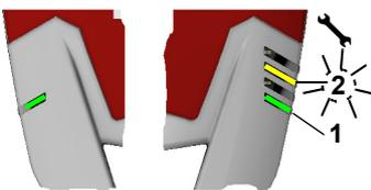
5. Während der Datenübertragung, die mehr als 5 Minuten dauern kann, leuchtet die Modem-LED (1) und die Service-LED (2) blinkt.
