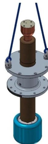
Рисунок 9. Строповка ввода
