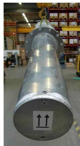
Рисунок 6. Защитная емкость
