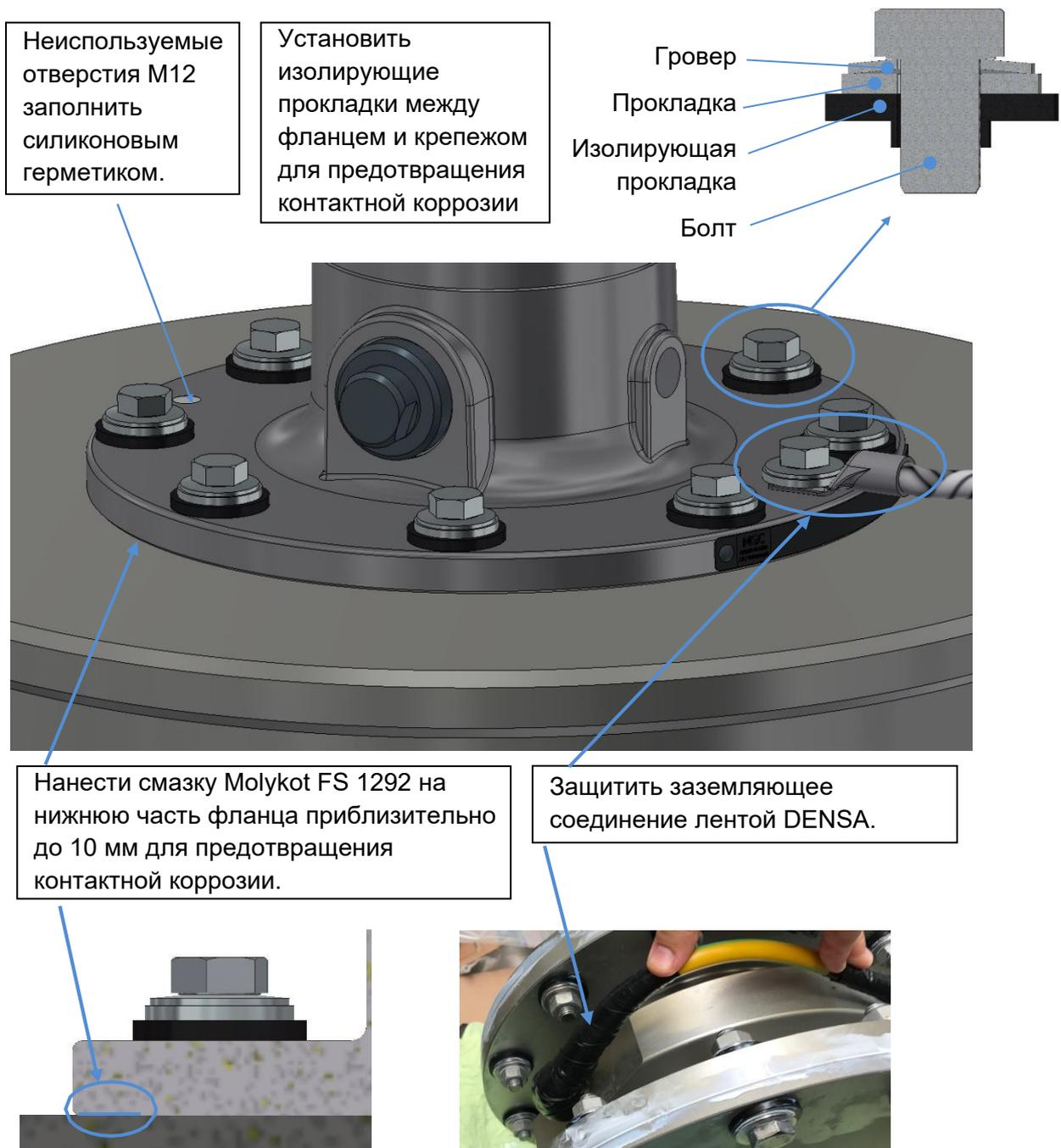
Рисунок 13. Дополнительная защита от коррозии
