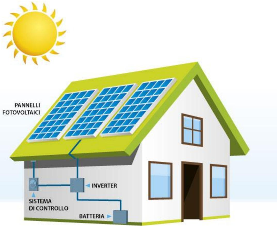
Gli impianti fotovoltaici ci consentono di produrre energia elettrica sfruttando la luce del sole. Ma come può avvenire questa trasformazione? Grazie all'effetto elettro-fisico chiamato fotovoltaico, che sfrutta l'energia contenuta nei fotoni della luce solare per attivare gli elettroni liberi delle celle fotovoltaiche al silicio che formano i pannelli solari.
