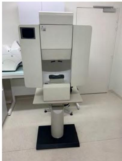
Matériel permettant de réaliser des mesures du champ visuel.
