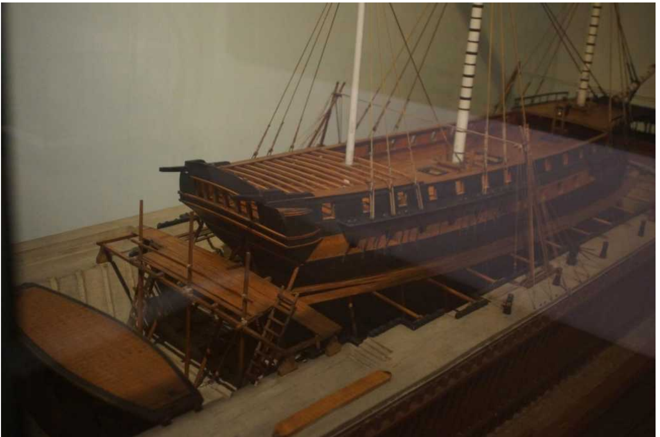
Le système mis en place pour radouber les bateaux et le bassin de radoub
