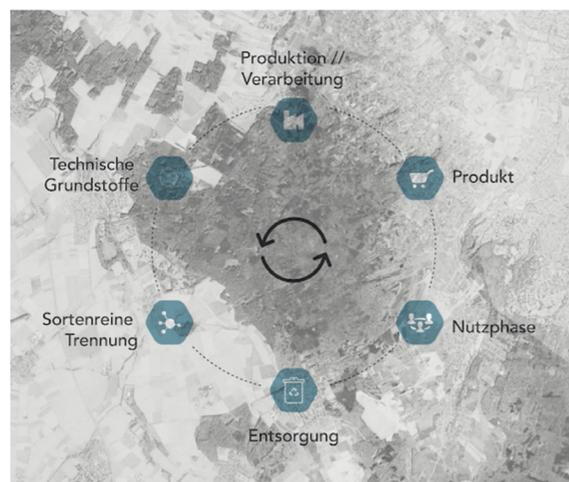
Der technische Kreislauf beinhaltet alle technisch hergestellten und rezyklierbaren Materialien. Hierfür ist eine sortenreine Trennung maßgeblich. Denn nur so lassen sich die Stoffe, durch Aufbereitungsverfahren wieder, zu technischen Grundstoffen machen. Dies trifft auf Kunststoffe, genau wie auf Metalle und verschiedene mineralische Stoffe, wie etwa Glas zu.
