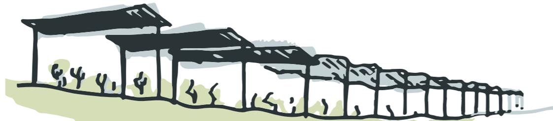
Bei der Solar - Agrarwirtschaft kommt es zu einer doppelten Nutzung des Offenlands. Neben der Solarfarm wird hier Gemüse angebaut. Dies löst den Nutzungskonflikt auf. Die Installation eines Solarackers ist allerdings mit einem verhältnismäßig großen Aufwand verbunden. Denn die Solarpanels müssen so angebracht werden, dass Landmaschinen unter ihnen arbeiten können.
