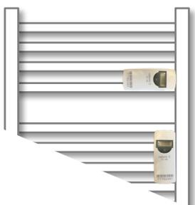
Bei geraden Querrohren vertikal auf Vorlaufseite, Display nach außen.
