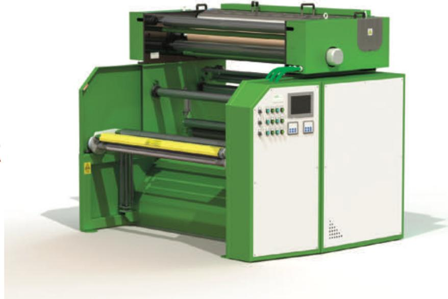
Werten Sie Ihre Folien und Papiere auf. Verschiedene Aggregate für **Lochungen, Perforationen (heiß oder kalt), zum Schlitzeln, zum Prägen, zum Markieren, zum Inspizieren/Prüfen oder eine Abrissperforation** findet Platz auf dem LPUR 01 Umroller.
