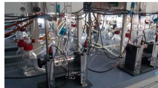
Ussing-Kammer zur Untersuchung funktioneller Charakteristika von Epithelien unter verschiedenen Bedingungen im Labor (Foto: sjn)
