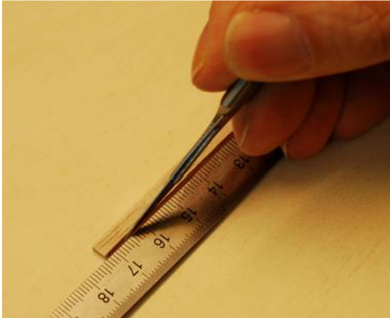
Abb. 3: Einschneiden der Isolierung
