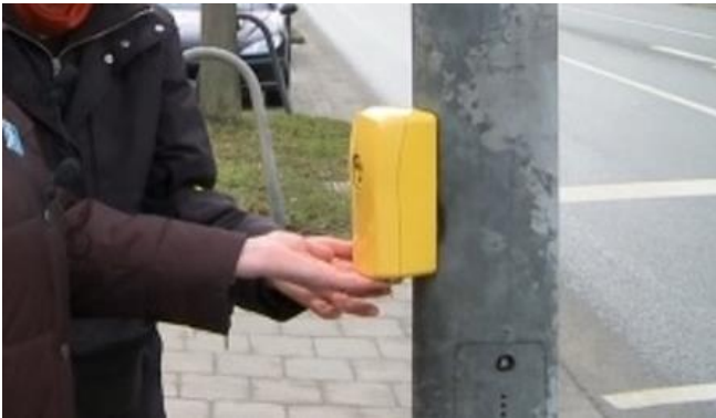
Unten am Ampelschalter befindet sich manchmal ein Vibrationsalarm für Blinde (Quelle: AMD-Netz)
