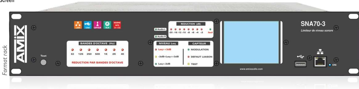
Le **SNA70-3** est un limiteur de pression acoustique permettant une limitation simple et efficace des niveaux sonores ambiants par niveau global et par bande d'octave. La technologie mise en œuvre pour la limitation sonore en global ne dégrade absolument pas la dynamique du signal comme le ferait un compresseur traditionnel.
