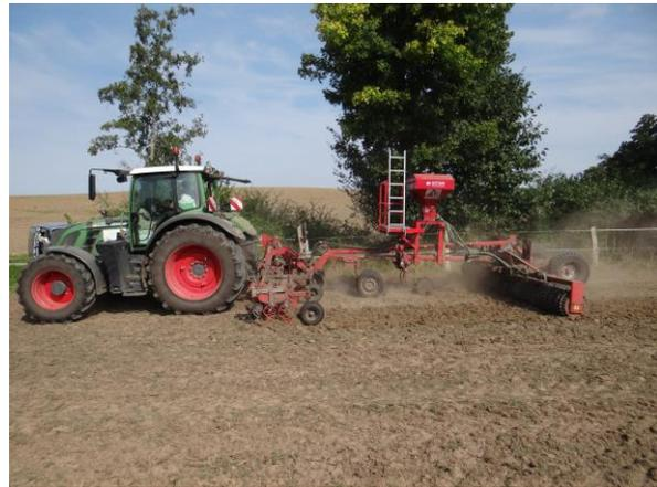
Abb. 8: Einsaat von Regio-Saatgut mit einem modernen pneumatischen Saatstriegel. Der Striegel läuft „vorweg“. Er braucht nicht hochgestellt werden (Anm. siehe Text, Foto D. Finke)
