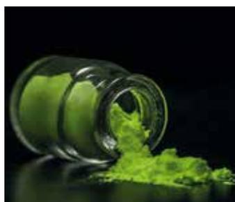
Pigmento fotoluminescente capace di immagazzinare energia luminosa per poi assumere al buio una colorazione verde. Il suo impiego consente la produzione di un'ampia gamma di materiali fosforescenti quali: vernici, smalti, resine, materie plastiche utilizzabili per decorazioni, oggettistica, belle arti e segnalazioni visibili in assenza di luce.
