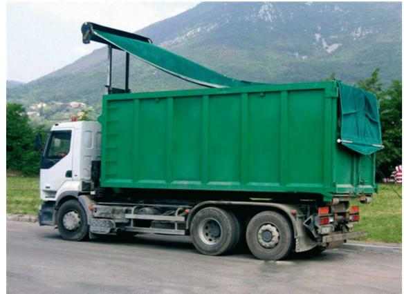
7. Die Taste „Senken“ drücken (Abb. 18), die Plane so absenken, dass sie die Ladefläche abdeckt, und die Seitenränder mithilfe einer mitgelieferten Stange herabziehen.
