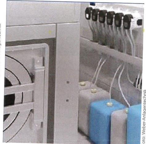
Automatische Dosierpumpen zur exakten Zugabe von Flüssigkeiten.
