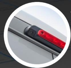
Die optionale Rückfahrkamera ist perfekt in die Abrisskante integriert & bietet Ihnen perfekte Sicht nach hinten
