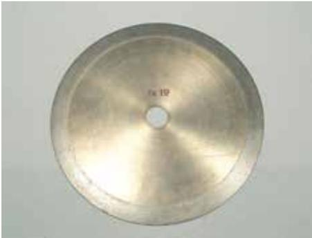
Bei diesen Diamant-Trennscheiben ist das Diamantkorn in Bronzebindung. Diese Trennscheiben eignen sich bestens zum Schneiden aller Mineralien und Steine. Sie haben eine mindestens 5 x höhere Standzeit als mechanische Trennscheiben und ergeben sehr saubere Schnitte. Die Belaghöhe ist 10 mm.
