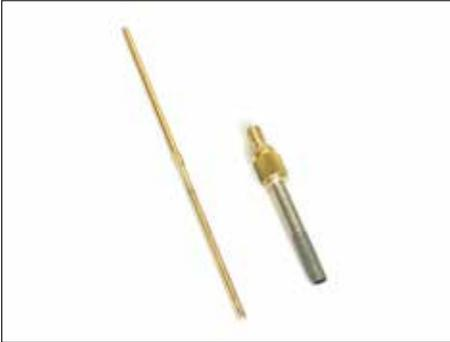
Bei diesen Bohrern besteht die Bohrkronen durch und durch aus Diamantkorn, wodurch die Lebensdauer nicht mit anderen, nur mit Diamantkorn belegten vergleichbar ist. Diese Bohrer haben eine hundertfache Standzeit gegenüber beschichteten, weil die Bohrkronen bis zum Schluss benutzt werden kann. (Ein nur beschichteter Bohrer ist, wenn die wenigen Diamantkörnchen an der Stirnseite ausgebrochen sind, wertlos).
