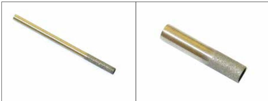
mit zylindrischem Schaft zum Einspannen in Bohrfutter. Bei diesen Bohrern besteht die Bohrkronen durch und durch aus Diamantkorn, wodurch die Lebensdauer nicht mit anderen, nur mit Diamantkorn belegten vergleichbar ist. Wenn die Bohrer nur galv. belegt sind, ist der Bohrer nach Abnutzung der paar Diamantkörner an der Stirnseite wertlos. Sie haben einen zylinderischen Schaft und eine Bohr-tiefe von 30 - 40 mm.
