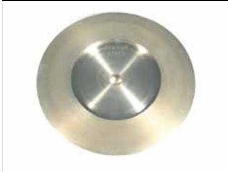
Bei diesen schweren Stahlscheiben aus deutscher Fertigung ist das Diamantkorn in einer Lage in Nickel gebunden. Sie haben einen Außendurchmesser von 150 mm und eine Belagbreite von 32,5 mm.
