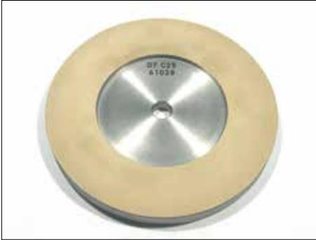
Gesinterte Diamantscheiben, bei denen das Diamantkorn in einem 0,5 mm dicken Bronzebelag eingebettet ist. Dadurch haben Sie eine wesentlich höhere Lebensdauer als galvanisch gebundene Scheiben. Sie haben einen Außendurchmesser von 150 mm und eine Belagbreite von 32,5 mm.
