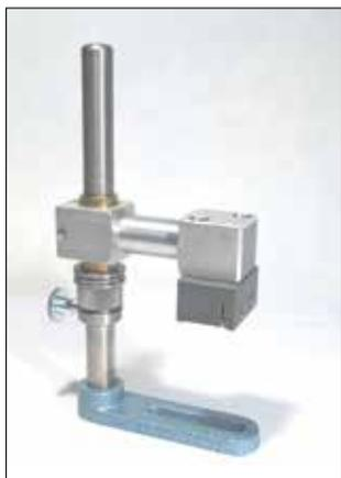
zum Sägen und Feinschleifen von Dünnschliffen auf dem Glasträger auf wenige hundertstel Millimeter Dicke, mit Diamantscheiben oder einer Gußscheibe mit Schleifpulvern. Die Dünnschliffe werden für Dias oder für Microfotografien verwendet. Passt auf alle Lapida-Maschinen und die Facettiereinrichtung der Multi-Motoren. Der Dünnschliffarm läuft dabei mit einer nachstellbaren Messingbuchse auf einem Axiallager.
